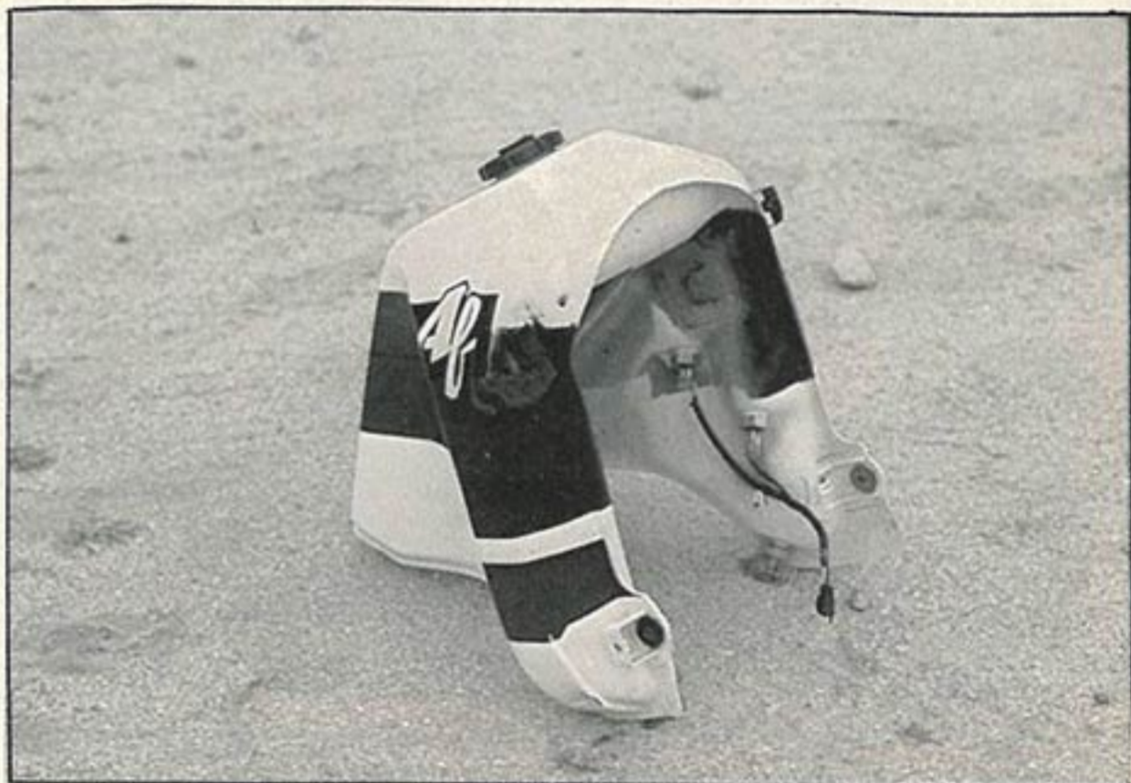
Veinticinco litros de capacidad, llave manual de paso y dos chivatos de reserva que se encienden cuando quedan 7 y 4 litros. En la foto se pueden ver los contactos previstos a estos dos niveles.
