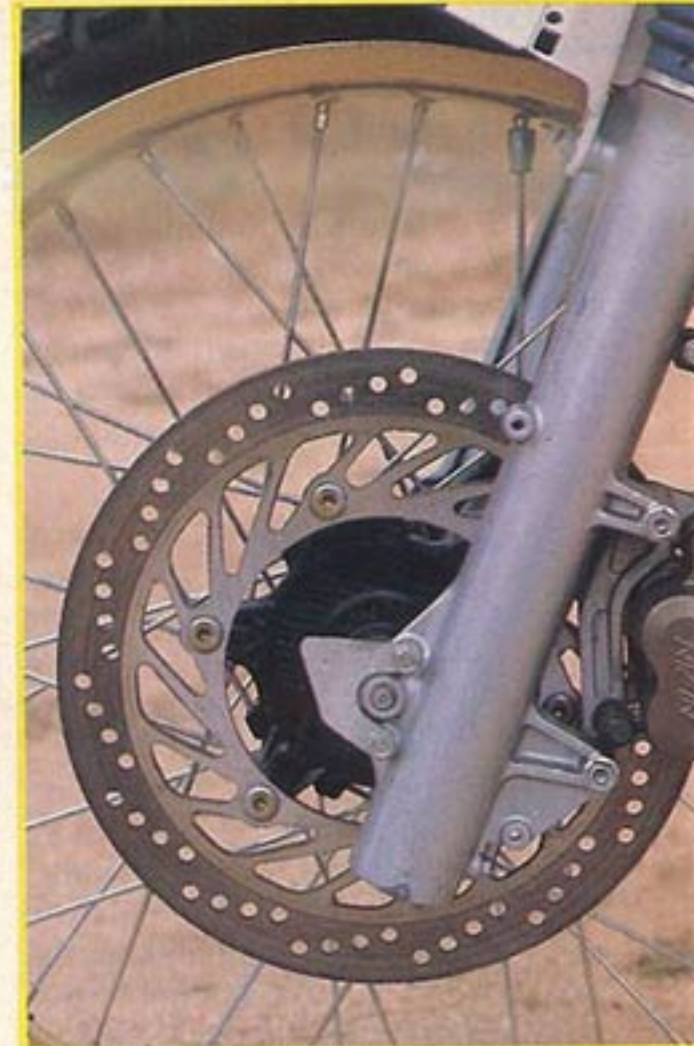
El freno de disco trasero, basculante de aluminio con nueva geometría pro-link, horquilla con barras de 43 mm. y el potentísimo disco delantero de 296 mm. con pinza de doble pistón son decisivas ventajas de la Africa Twin.
