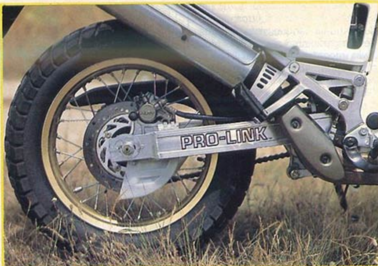
El freno de disco trasero, basculante de aluminio con nueva geometría pro-link, horquilla con barras de 43 mm. y el potentísimo disco delantero de 296 mm. con pinza de doble pistón son decisivas ventajas de la Africa Twin.
