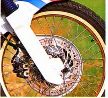
L'IMPIANTO FRENANTE È DI BUON LIVELLO, MA IL PESO COMPLESSIVO DELLA MOTO HA CONSENTITO DI OTTENERE SOLO MEDIOCRI SPAZI DI ARRESTO. SULLA RUOTA ANTERIORE C'È UN UNICO DISCO DA 296 Ø, FISSO, SOLLECITATO DA UNA PINZA NISSIN A DOPPIO PISTONCINO PARALLELO, MENTRE POSTERIORMENTE C'È UN DISCO DA 240 MM Ø
