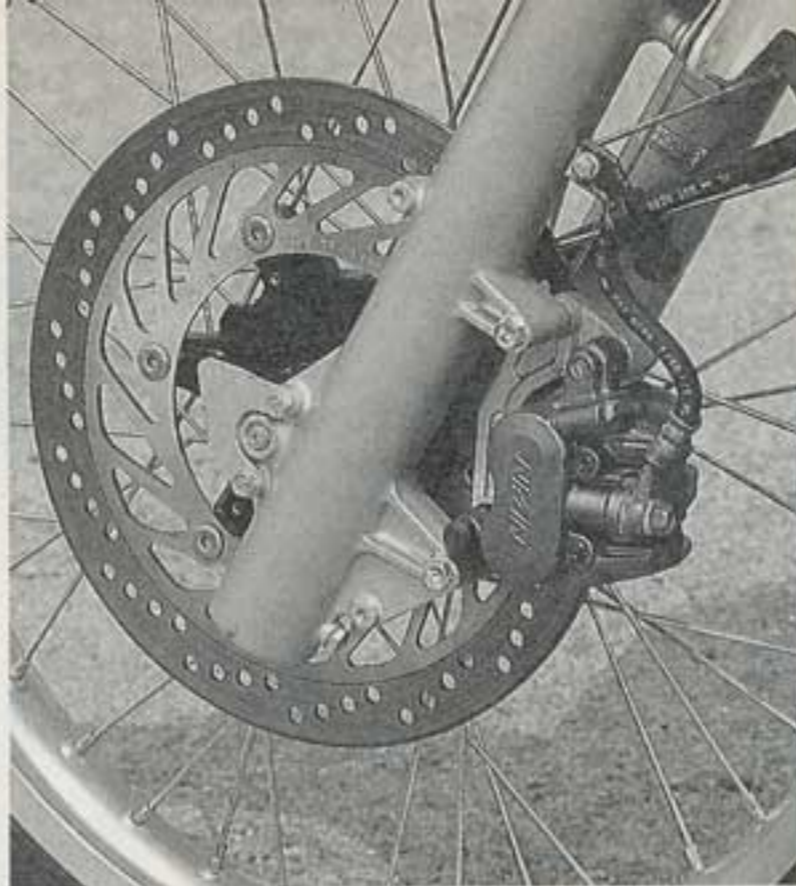
Il «monumentale» disco anteriore è equipaggiato con una pinza a pistoni affiancati, dietro invece lavora una ganaschia monopistone. Da osservare le belle feritoie di alleggerimento.
