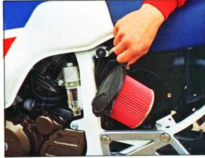
Tolte le fiancate si trovano a destra il filtro in carta, a sinistra la batteria ed il serbatoio per il liquido del freno posteriore. La fiancata di sinistra è schermata internamente contro il calore della marmitta e reca anche una custodia per i documenti. Davanti al filtro, sul montante del telaio, il serbatoio del gas per l'ammortizzatore con dispositivo per la regolazione della compressione.
