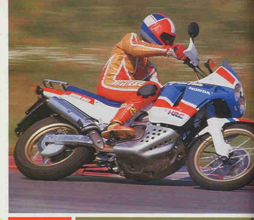
L'Africa Twin adotta un motore bicilindrico a V di 52° raffreddato a liquido con distribuzione monoalbero in testa e tre valvole per cilindro. La trasmissione è a catena. Il telaio è in tubi quadri e tondi con cuila sdoppiata, la sospensione anteriore è con forcella pneumoidraulica e la posteriore топо progressiva Pro-Link. La frenata è
