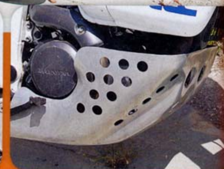
Θηριώδης διαστάσεις έχει η αλουμινένια ποδιά, η οποία χωρίζεται σε τρία τμήματα. Οι τρύπες επιτρέπουν στην αποβολή της θερμότητας και την ψύξη του κινητήρα
