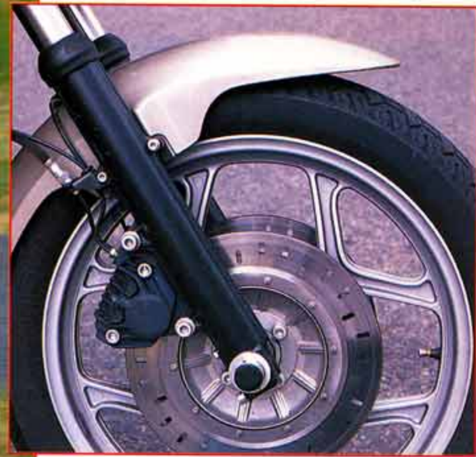
Double disque et étriers Brembo sur la LT, mais la puissance est insuffisante en conduite rapide.
