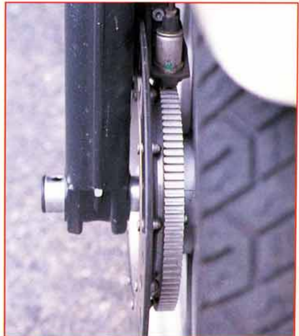
Ces deux vues montrent (presque) tout le système ABS: le modulateur de pression (photo de gauche) qui agit sur le maître-cylindre du frein AR et la roue dentée qui transmet les informations au capteur que l'on aperçoit juste au-dessus.
