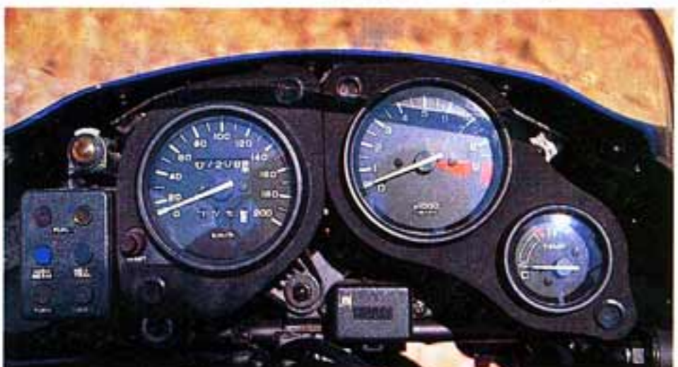
Ambiance usine pour l'Africa-Twin qui propose un tableau de bord lisible et agréable à l'œil. Un témoin de béquille latérale y est présent.
