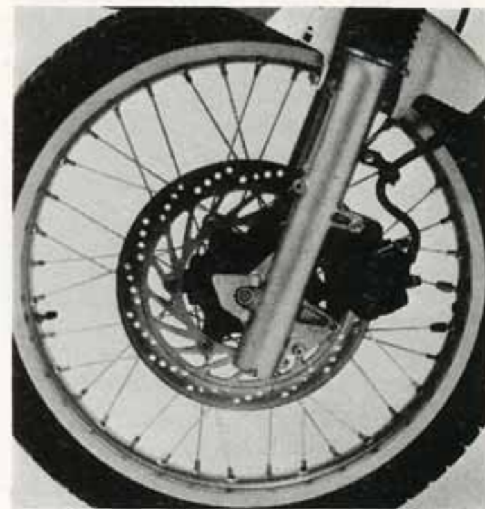
Le frein avant à double piston de la Honda est assez puissant et progressif. Sous le garde-boue, un arceau empêche la fourche de vriller au freinage.
