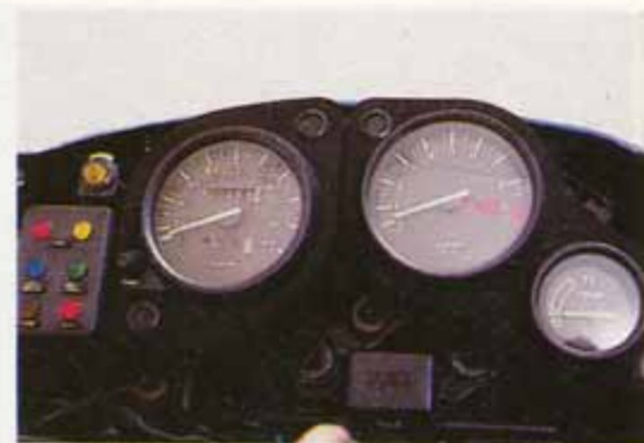
Fixé dans le nez de carénage, le tableau de bord est complet. Les voyants orange et rouge sont ceux de réserve d'essence.
