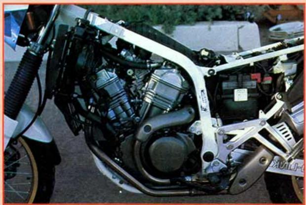
Vue latérale droite : échappement batterie, relais de démarreur (avec son fusible et un fusible de rechange), réservoir de lock-heed frein arrière, radiateur et ventilateur.
