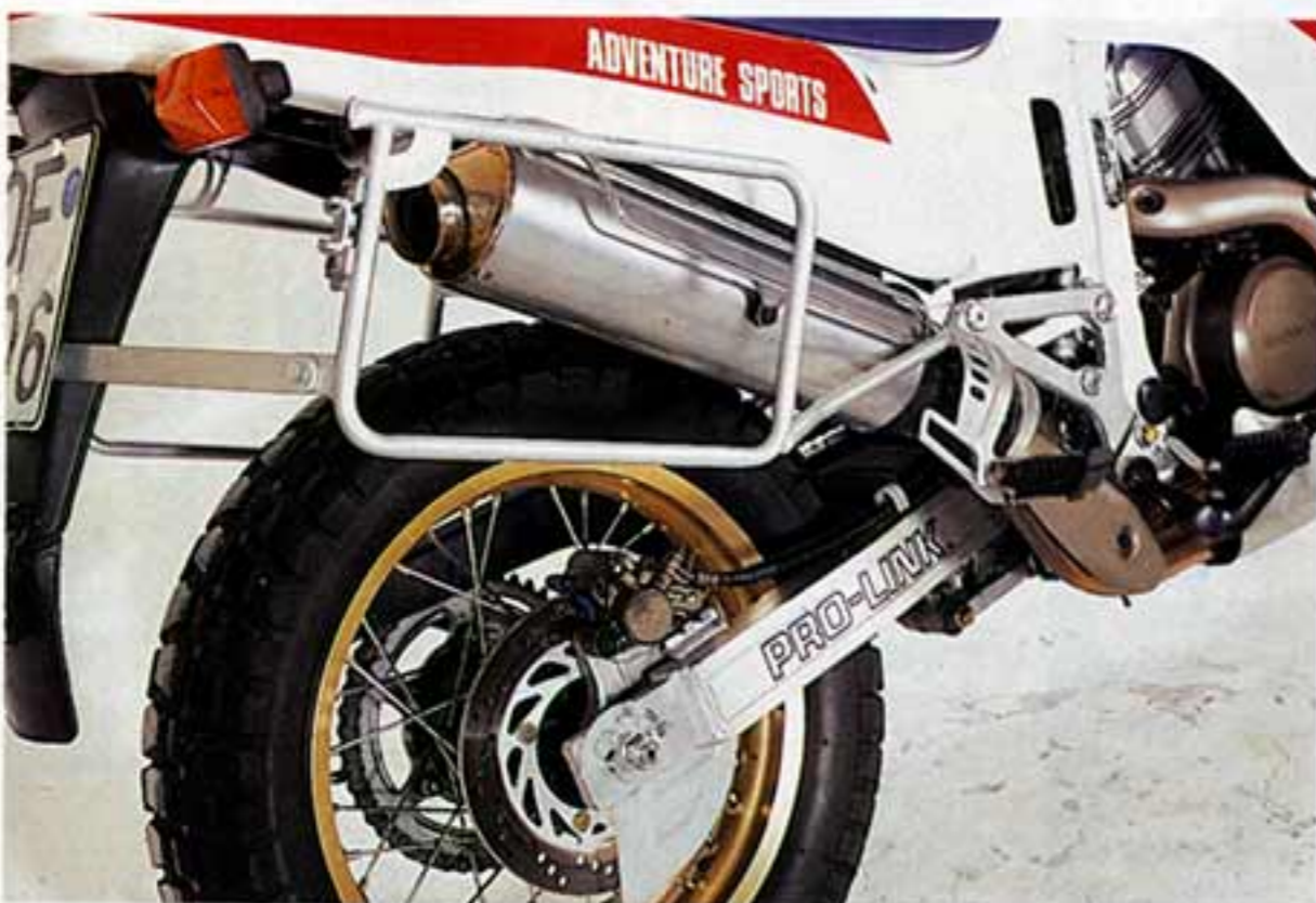
Die Sitzposition ist noch besser als auf der Transalp. Der Träger stammt von Hepco & Becker und baut auf der Auspuffseite sehr breit. Die Schwinge ist aus Aluminium, die Kette leider ungeschützt.
