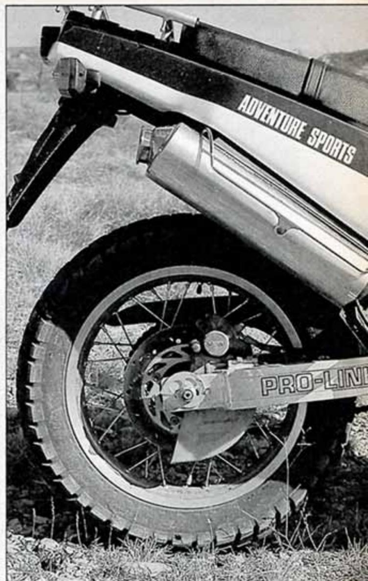
Die hintere geschlitzte Scheibenbremse neigt leider zum frühzeitigen Blockieren
