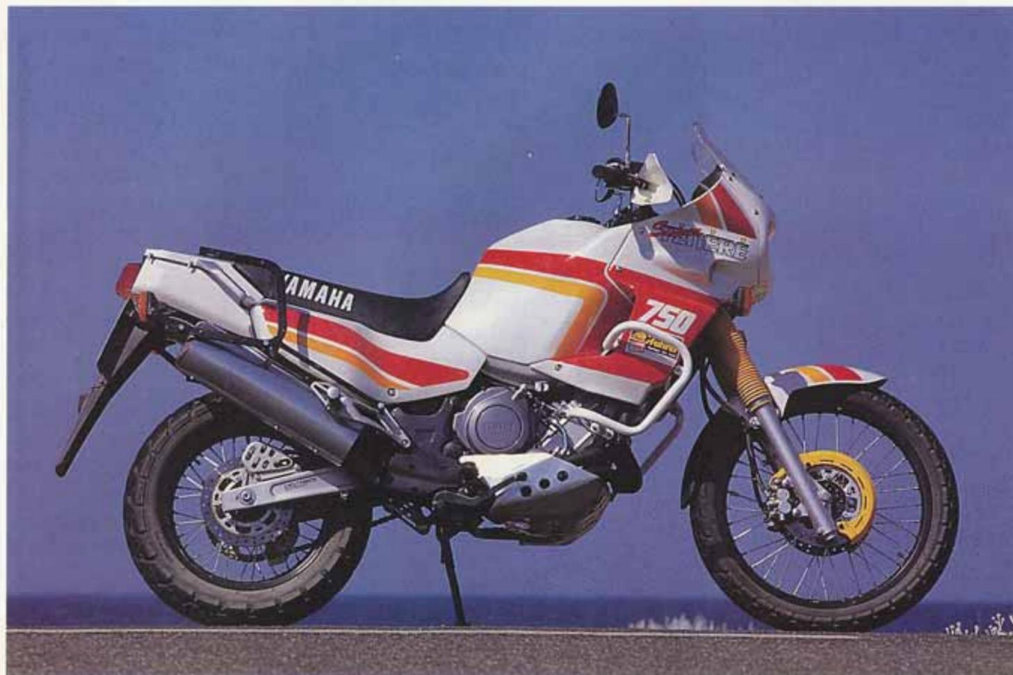
**Mit kurzem Radstand und steil stehender Gabel ist die Super Ténéré auf Handlichkeit getrimmt. Trotzdem läuft sie bei hohen Geschwindigkeiten einwandfrei geradeaus. Die doppelte Scheibenbremse im Vorderrad läßt zu wünschen übrig. Für echte Endurotouren erfordert die kopflastige Yamaha viel Fahrpraxis.**
