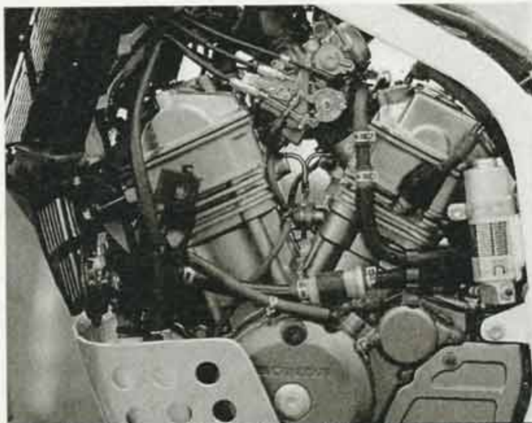
Der vibrationsarme Honda-Dreiventiler mit Doppelzündung hat den geringsten Verbrauch
