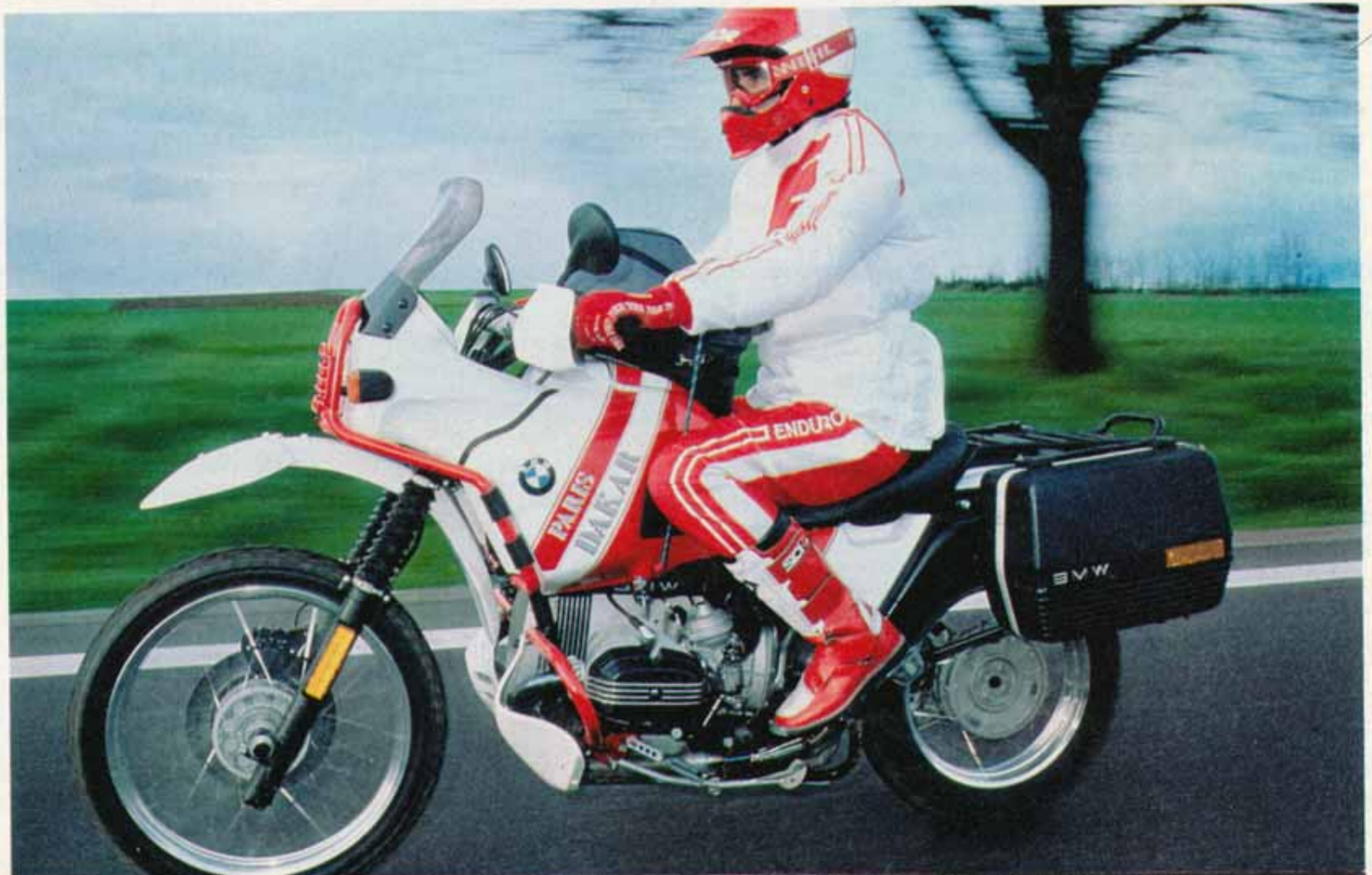
Die Fußrasten der Paris-Dakar liegen weit hinten. Wahlweise paßt die Zweimann-Bank der Standard-GS
