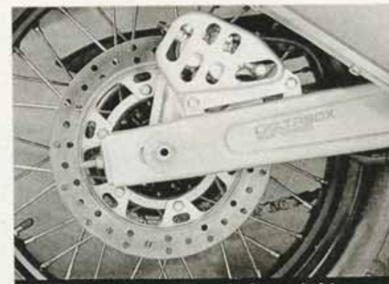
. . . die der Yamaha der ihren leider auch. Die Schwinge ist aus Stahl
