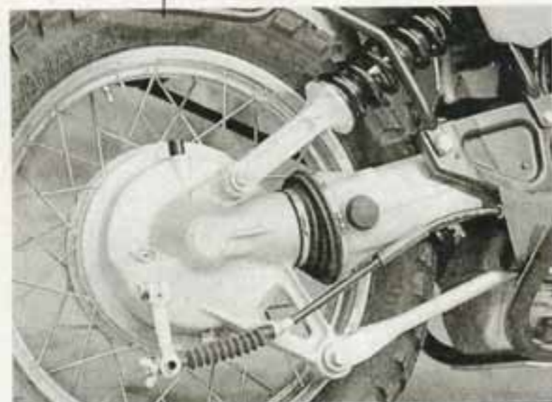
Die BMW-Trommel verzögert nur bei höchstem Kraftaufwand gut
