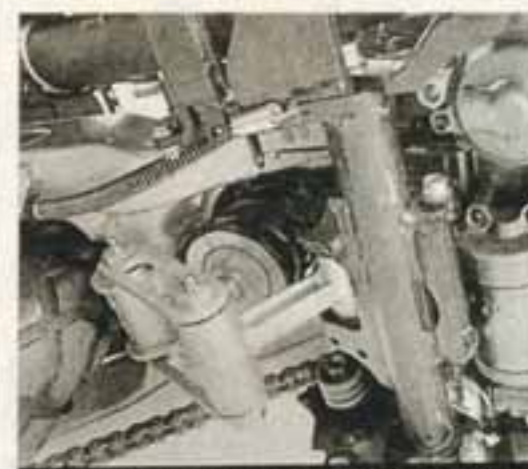
Die Federbasisverstellung der Super Ténéré ist nur von unten erreichbar
