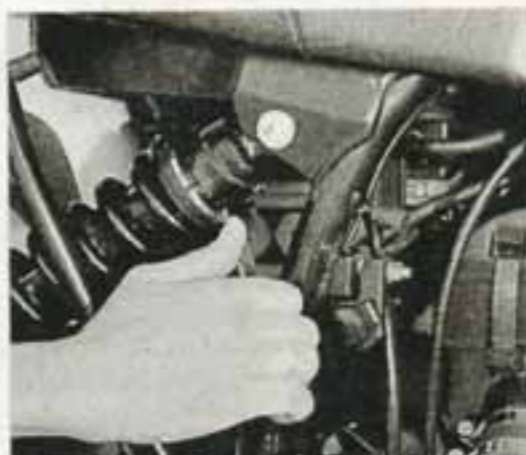
Einfache Federbasisverstellung der Paris-Dakar per Hakenschlüssel
