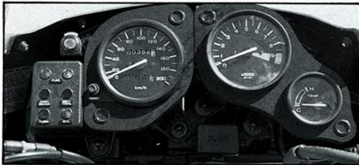
Cockpit und Verkleidung sind rahmenfest montiert
