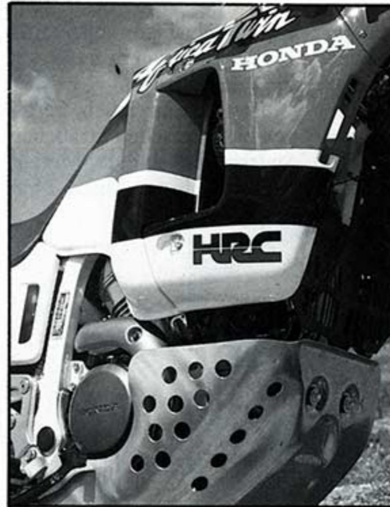
Ein gewaltiges Leichtmetall-Teil schützt den Motor
