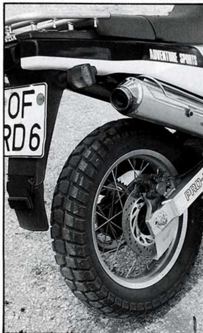
Das Reifenprofil ist auch gut fürs Gelände geeignet
