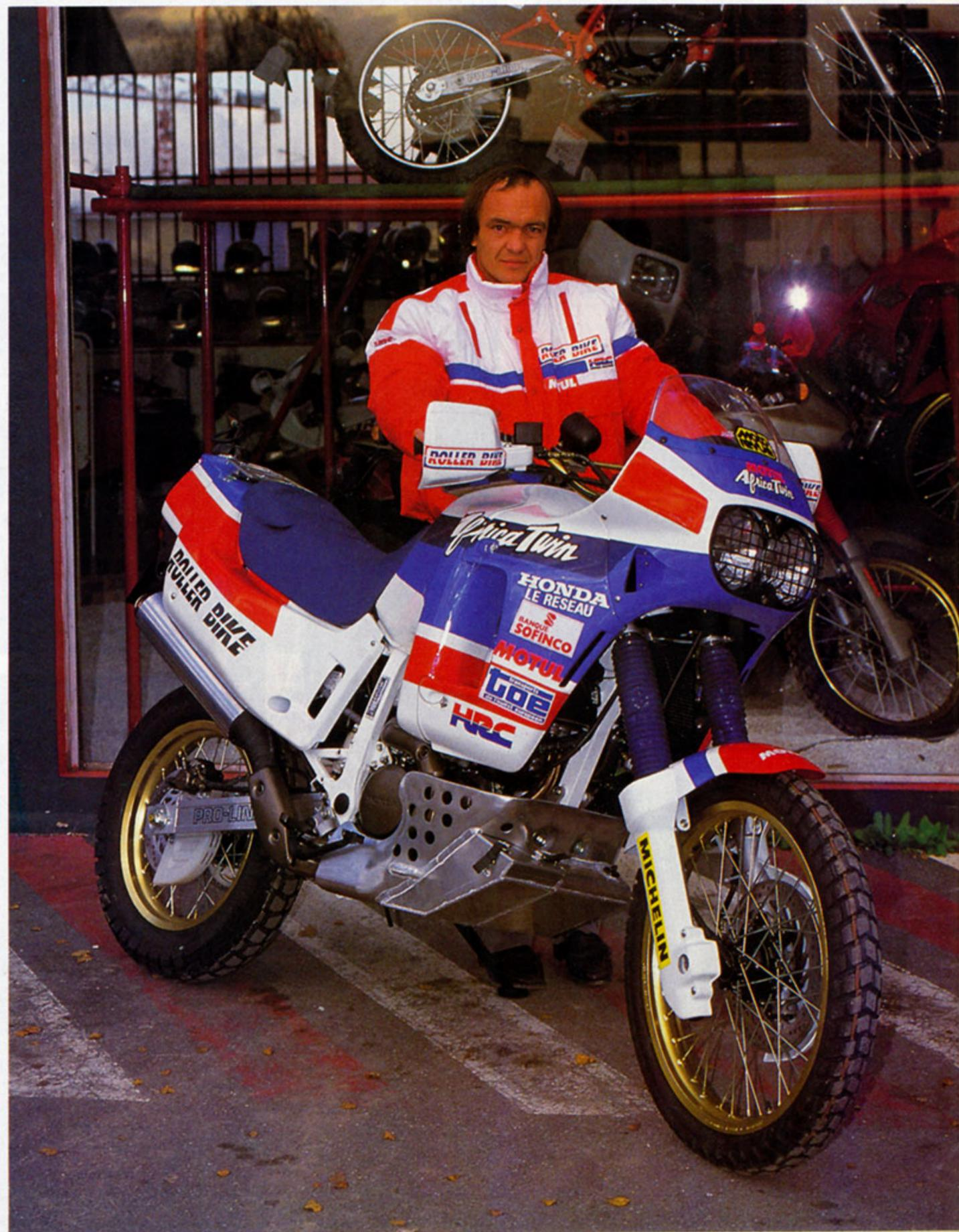
roue sans les démonter. L'énorme sabot moteur contient maintenant la réserve d'eau obligatoire pour les étapes désertiques, ainsi qu'une trousse à outils assez complète : les clés de première nécessité, trois démonte-pneus et quelques tubes de pâtes-miracle pour colmater les éventuelles fuites d'un carter ou des réservoirs.
