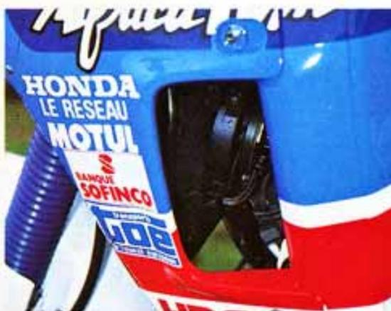
*Le modèle 1990 reçoit un second ventilateur pour un refroidissement optimum malgré l'imposant réservoir.*
